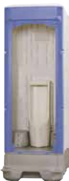
W845×D1,555×H2,470 重量…88kg 給水タンク60L/便槽330L 扉付
